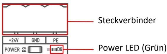
Der *DMX/RDM 16-Kanal Relaisplatine* benötigt 24V DC, die an die 3-polige Steckverbinder anzuschließen sind:
