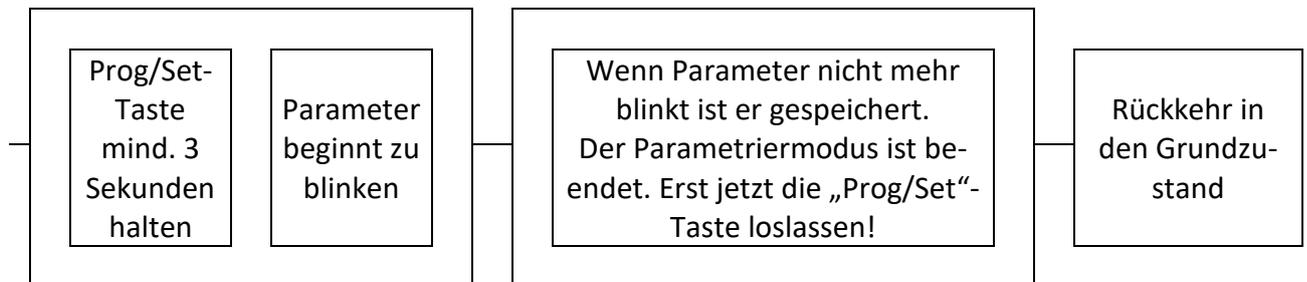
Im Parametriermodus gilt ebenfalls der Timeout für die Tasten. Wird innerhalb von 10 Sekunden keine Taste gedrückt, kehrt das Gerät automatisch aus dem Parametrier- in den Grundmodus zurück. Bereits eingestellte, aber nicht gespeicherte Änderungen der Parameterwerte werden nicht übernommen.
