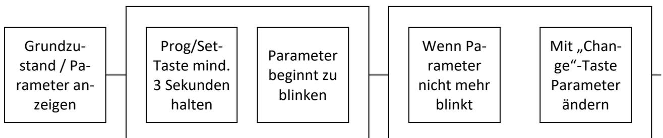
Durch Drücken der „Change“-Taste wird der Wert geändert. Längeres Drücken der „Change“-Taste aktiviert einen Schnelldurchlauf, der zum schnellen Einstellen hoher DMX-Adressen gedacht ist.
