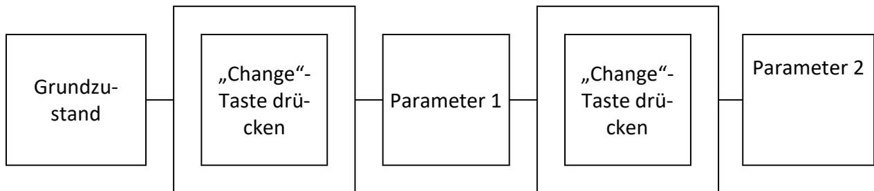
Das Menü besitzt einen Timeout von 10 Sekunden. Wird nach der letzten Eingabe kein Taster gedrückt, kehrt die Anzeige nach 10 Sekunden in den Grundzustand zurück. Dieser Timeout gilt auch beim Einstellen der Parameter. Bei einzelnen Parameteransichten ist der Timeout größer als 10 Sekunden (bis zu 1 Stunde).
