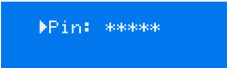
Die Eingabe der Pin erfolgt mit dem Encoder. Zur Sicherheit wird vor und nach dem Scrollen nur [\*\*\*\*\*] angezeigt.
