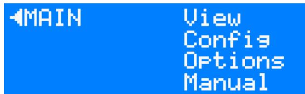
Im Grundzustand zeigt das Gerät eine der 11 Informationsseiten. Durch Drücken des Encoderrades für die Dauer von 1s gelangt man in das Hauptmenü des LSS PowerDim RM 2. Die Menüstruktur ist hierarchisch aufgebaut und umfasst Submenüs zur Information, Funktionseinstellungen und allgemeinen Geräteeinstellungen. Daraus ergibt sich in der Ebene 1 (rechte Spalte) die Bezeichnungen View, Config und Options. Der Aufbau der Untermenüs wird nun im Folgenden dargelegt.
