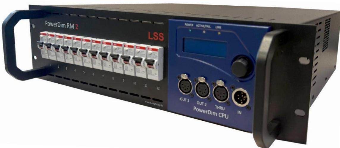
**19“ Thyristordimmer mit 12x 3 kVA, zuschaltbarer elektronischer Grundlast, Kühlmanagement und Personenschutz nach DIN EN VDE**
