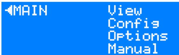
Im Grundzustand zeigt das Gerät eine der 11 Informationsseiten. Durch Drücken des Encoderrades für die Dauer von 1s gelangt man in das Hauptmenü des LSS PowerDim. Die Menüstruktur ist hierarchisch aufgebaut und umfasst Submenüs zur Information, Funktionseinstellungen und allgemeinen Geräteeinstellungen. Daraus ergibt sich in der Ebene 1 (rechte Spalte) die Bezeichnungen View, Config und Options. Der Aufbau der Untermenüs wird nun im Folgenden dargelegt.
