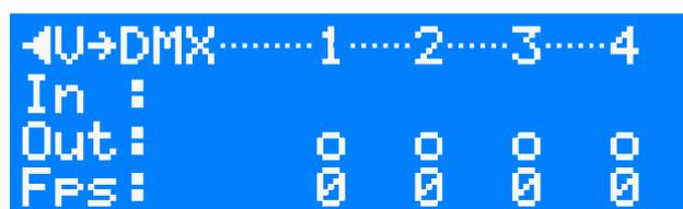
Das Menü View→DMX gibt einen Überblick über die Aktivitäten an den DMX- Anschlüssen. Dargestellt werden die DMX-IN, die DMX-OUT und die jeweiligen Framerraten des Ports. Der MasterPort 2 PSU besitzt systembedingt nur DMX-OUT-
