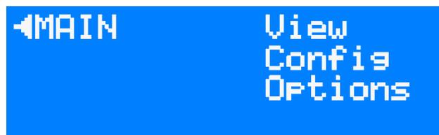
Im Grundzustand zeigt das Gerät eine der 7 Informationsseiten. Durch Drücken des Encoderrades für die Dauer von 1s gelangt man in das Hauptmenü des LSS MasterPort 2 PSU. Die Menüstruktur ist hierarchisch aufgebaut und umfasst Submenüs zur Information, Funktionseinstellungen und allgemeinen Geräteeinstellungen. Daraus ergibt sich in der Ebene 1 (rechte Spalte) die Bezeichnungen View, Config und Options. Der Aufbau der Untermenüs wird nun im Folgenden dargelegt.
