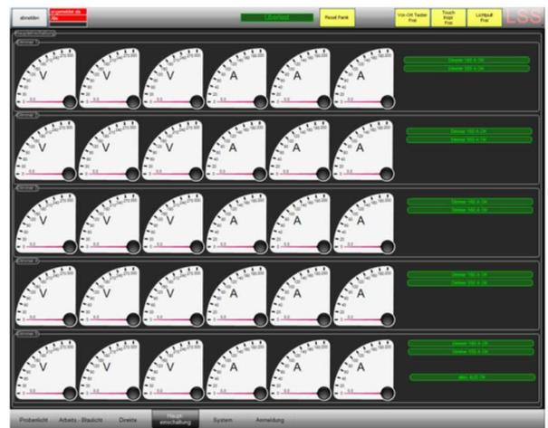
Beispiel für Überwachung anliegender Ströme und Spannungen.
