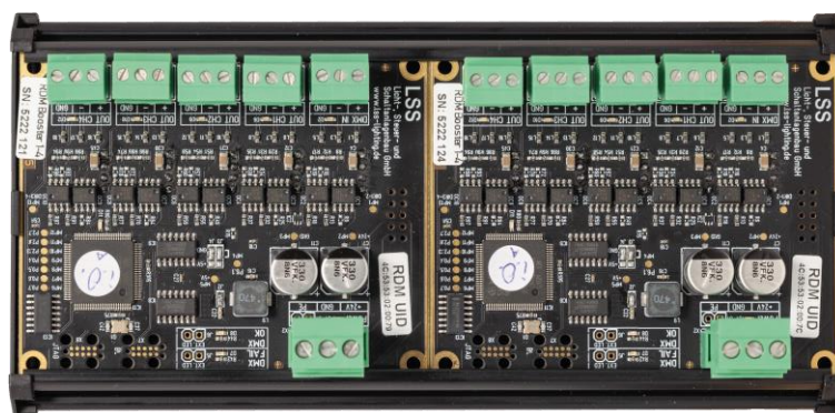
Beispiel eines Doppel-Booster mit zwei DMX-RDM Booster 1 in 4
