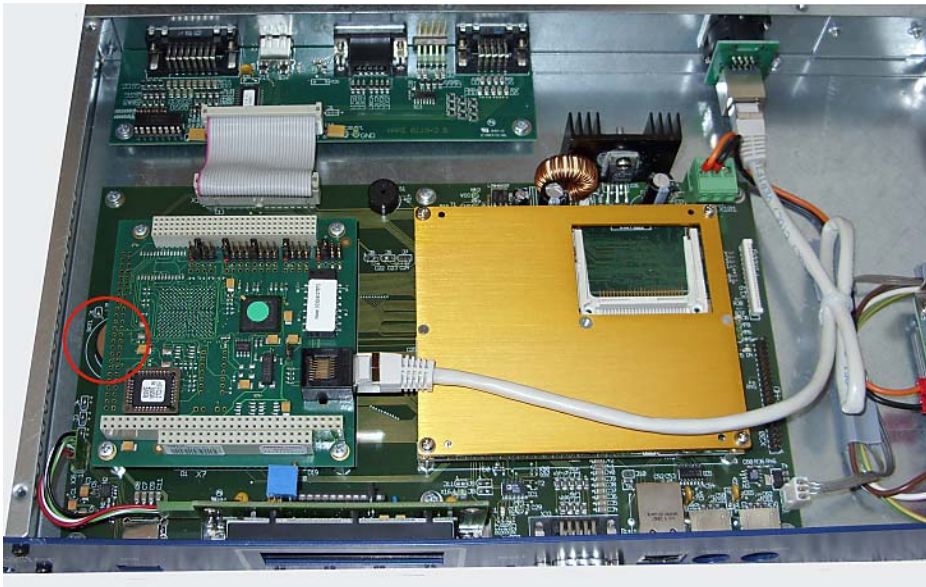
Innenansicht des ipMaster mit Lithiumzelle
